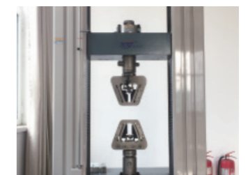
拉伸试验装置
